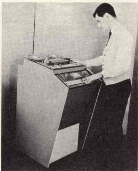
Si ritiene che questo registratore Tipo 311 sia il primo del mondo nel quale il blocco delle testine può essere rovesciato a piacere. Tale caratteristica permette l'uso di nastri con strato di ossido avvolto all'interno o all'esterno, conformemente allo standard angloamericano e a quello europeo.
