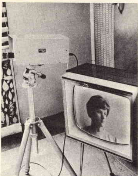
Ecco un'immagine televisiva ricevuta da una telecamera a transistori che è stata costruita con i materiali forniti dalla Beulah Electronics di Londra.
